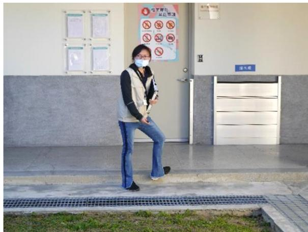
排水溝、地平墊高、擋水板
